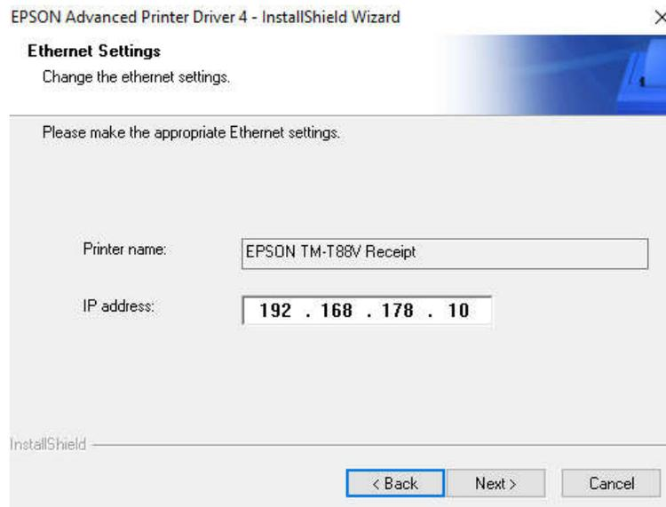
Bei der LAN-Schnittstelle erfolgt im folgenden Fenster die Abfrage der IP-Adresse. Bei anderen Schnittstelle läuft die Treiberinstallation ohne Abfrage einfach weiter.
