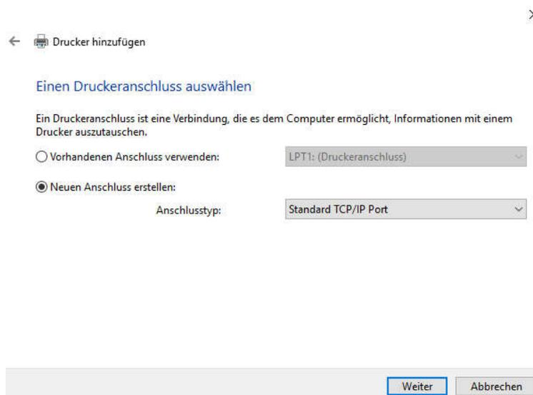
Klicken Sie auf „Neuen Anschluss erstellen“ und wählen Sie als Anschluss „Standard TCP/IP Port“ aus. Analog zu 2.1 können Sie unter „Anschlusstyp“ die benötigte Schnittstelle (seriell, parallel, USB) auswählen.
