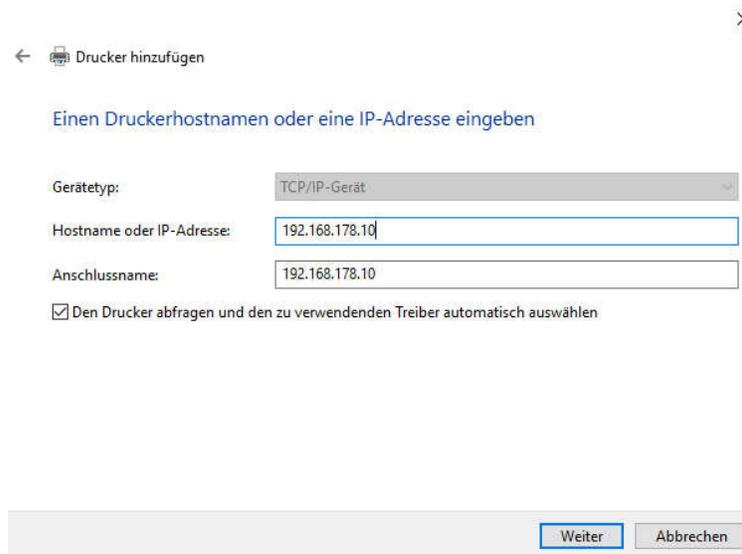
Bei der LAN-Schnittstelle erfolgt im folgenden Fenster die Abfrage der IP-Adresse. Bei anderen Schnittstelle läuft die Treiberinstallation ohne Abfrage einfach weiter.
